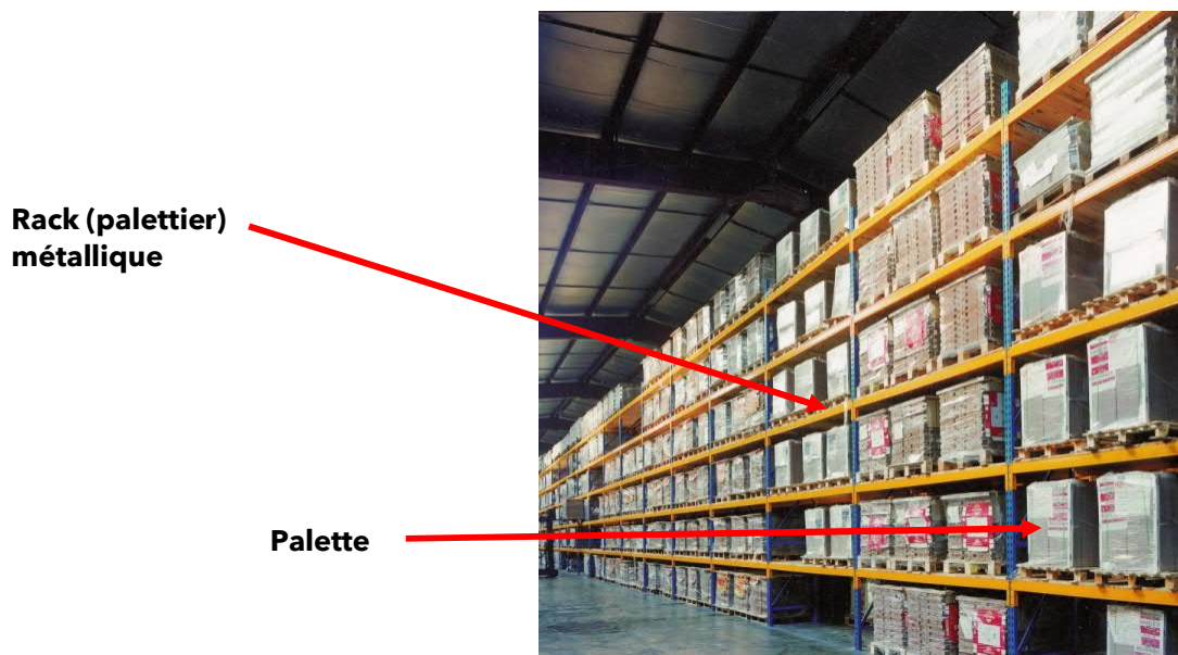
Figure 1 : Exemple de stockage sur racks (sol + 5)
