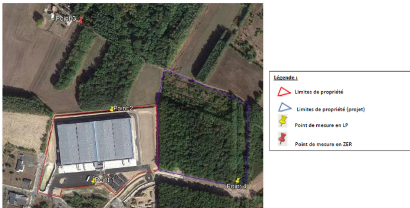
Figure 30 : Etude acoustique (source : SOCOTEC - 2022)
