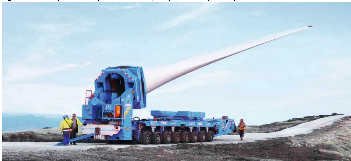
Figure 139 : Exemple de remorque avec « blade lifter » pour le transport des pales
