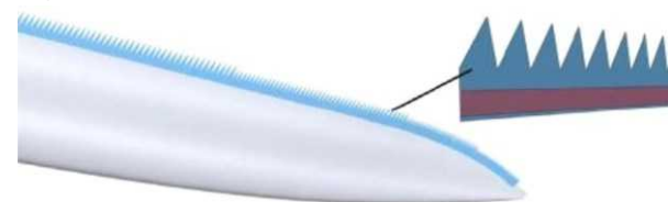
Figure 152 : Schéma de principe de serrations sur les pales de l'éolienne
