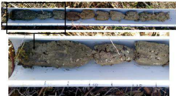
Figure 70 : Sondage n°2 - Détails de remblais argileux lourd calcaire sur sol en place (entre 0 à 40 cm de profondeur) (Source : Chambre d'Agriculture du Loiret)
