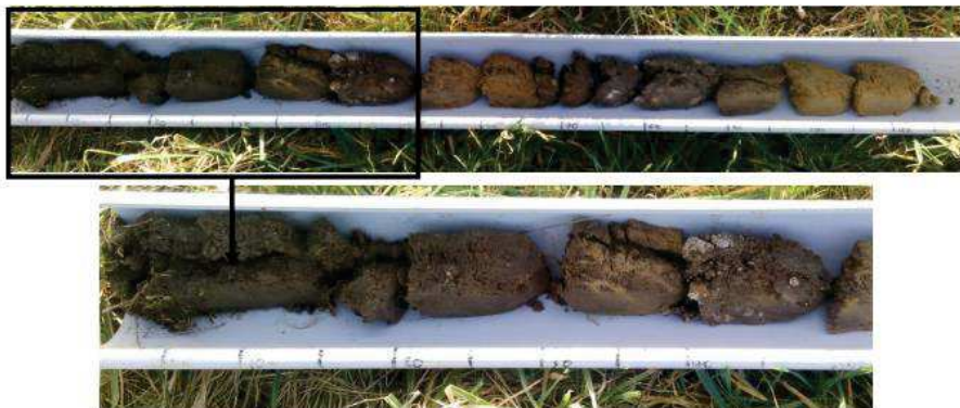
Figure 71 : Sondage n°4 - Sol anthropisé en surface, argilo-sableux sur sol en place ; détail de remblais argileux lourd calcaire (Source : Chambre d'Agriculture du Loiret)
